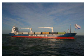
Frachtschiffneubau: MS „Beluga SkySails“ - MPP, 10.000t, 15 Kn - 160m 2 Kite (2008) - 320m 2 Kite (optimale Größe) Nachrüstung 2009
