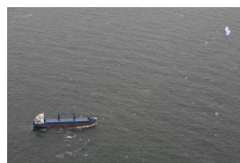
Frachtschiffnachrüstung: MS „Michael A.“ - Minibulker, 4.000t, 11 Kn - 160m 2 Kite (optimale Größe)
